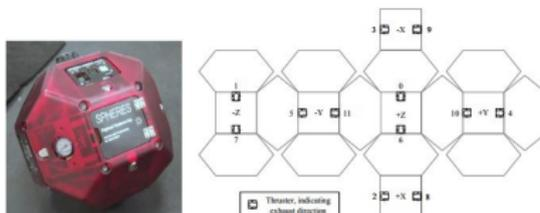
Il movimento avviene per mezzo di 12 propulsori (*thruster*) ciascuno dei quali può essere azionato per 0.2 sec e fornisce una forza di 0.12 N. Il movimento viene attuato attivando 2 propulsori contemporaneamente per una forza impulsiva di 0.24 N per un massimo di 0.2 sec. Se vogliamo applicare una forza di  $f$  N per 1 sec i due propulsori debbono essere accesi per un tempo  $\Delta t$  tale che l'impulso prodotto sia uguale a quello richiesto. Quindi
